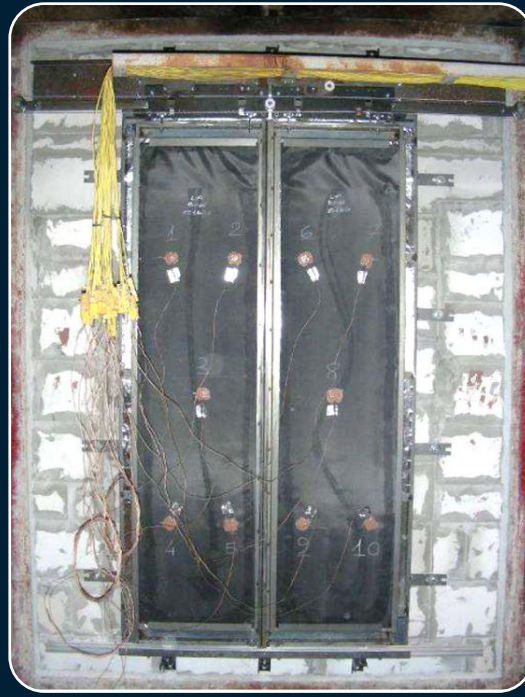
Resim 1: Yangına dayanım testi sırasında kapı panelleri üzerindeki termal sensörler.
